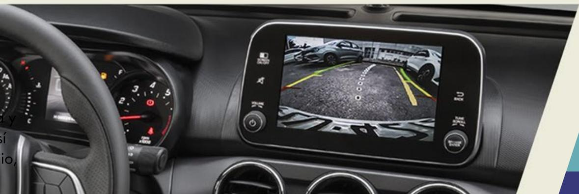
Tu perspectiva será mayor cuando la cámara y sensores se activen al cambiar a reversa y así obtendrás una visión trasera de ángulo amplio, detectando objetos detrás del vehículo.
